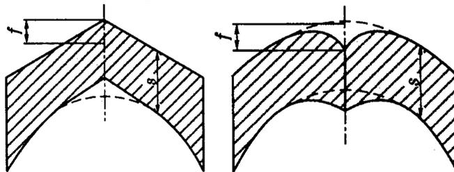
Рис. 1. Увод (угловатость) кромок в сварных швах
