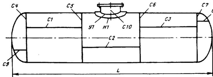
Примечание. Все участки сварных швов, подвергаемых контролю, в том числе места пересечения швов, должны быть обозначены на схеме.
